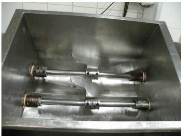
FOTO 11: Máquina misturadeira, que serve para misturar as carnes do recheio com o tempero.
