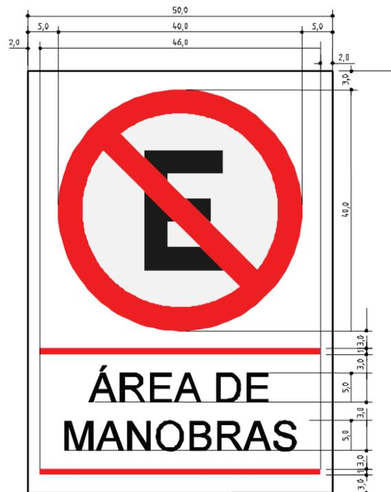
Figura N.º 59 - Exemplo de tipos esquemáticos de placas especiais: detalhe construtivo.
