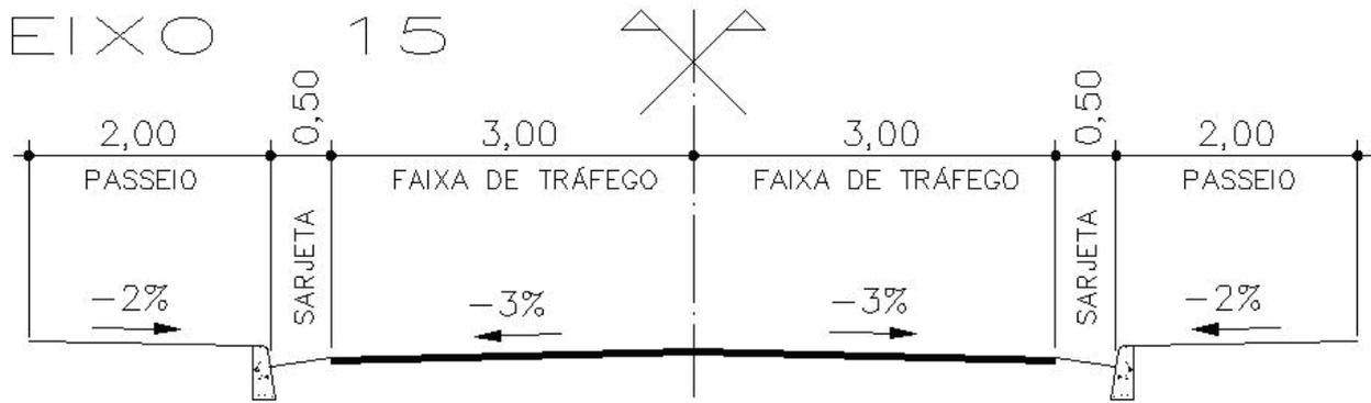
Figura N.º43 - Exemplo de seção transversal de uma via sobre um dado eixo.
