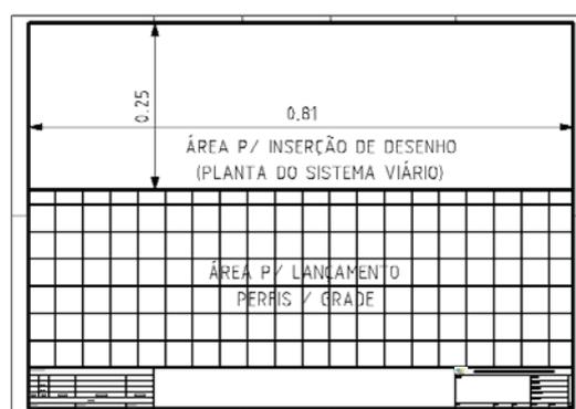
Obs.: O projeto deverá ser apresentado em prancha de formato padrão contendo a **planta**, na parte superior da prancha, **perfil / grade** na parte intermediária da prancha e a **seção tipo** na parte inferior da prancha.
