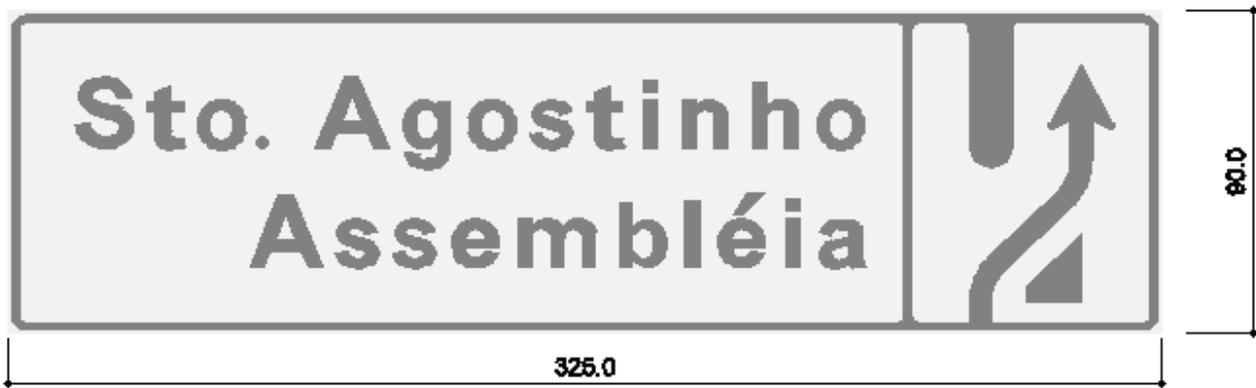
Figura N.º65 - Dimensões totais da placa diagramada.
