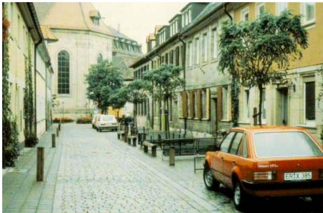
*Figura 3.11: Estreitamento ao longo de toda a via, com baía de estacionamento e elementos verticais. (Foto: IREC/GCR).*
