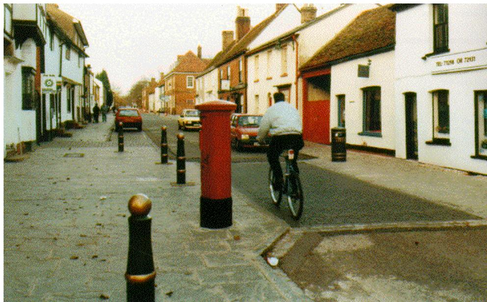
*Figura 5.6: Combinação de medidas: estreitamento de via, plataforma e tratamento da faixa de estacionamento (Foto: CSS)*
