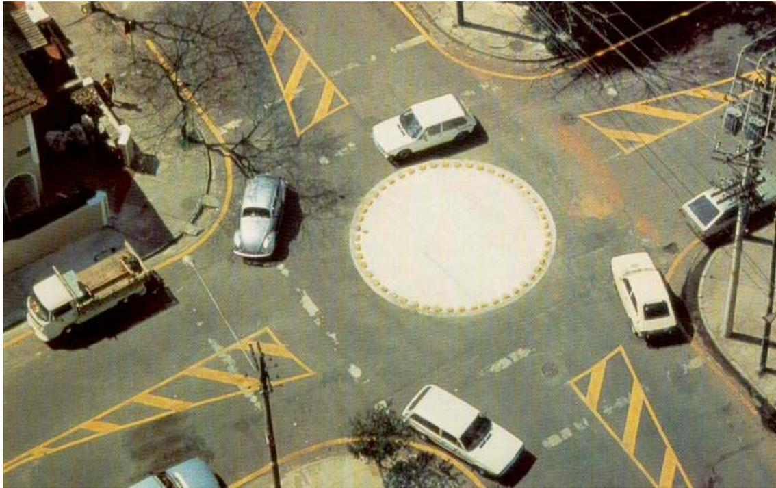
*Figura 3.14: Rotatória executada com “tartarugas” e pintura (Foto: ANTP).*
