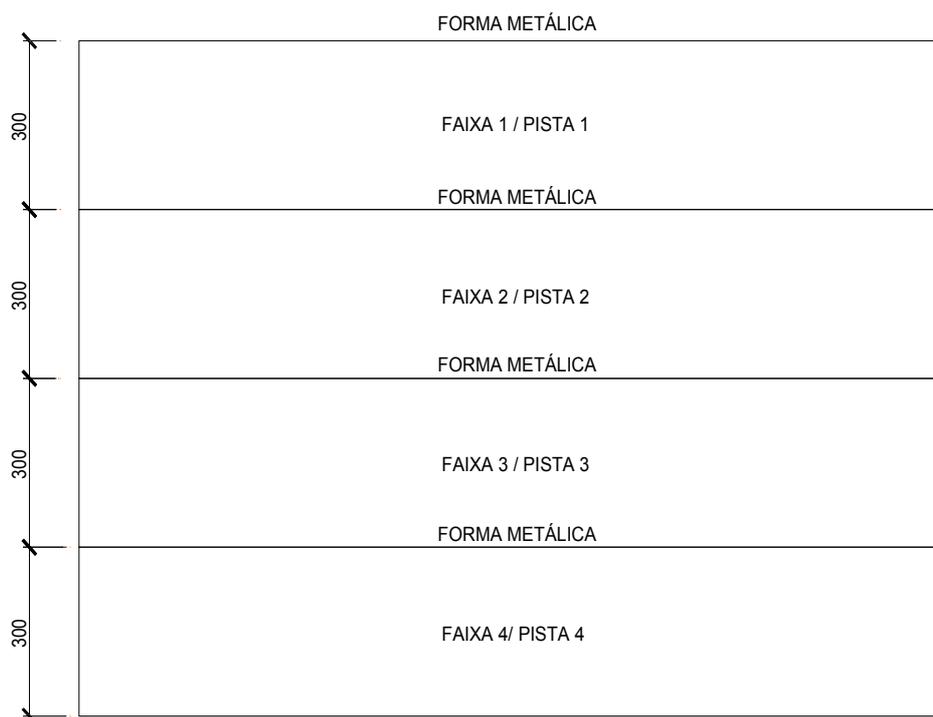
*Figura 2 – Concretagem das pistas*
