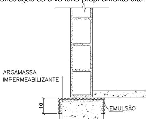
Figura 14 – Impermeabilização na base de baldrame
